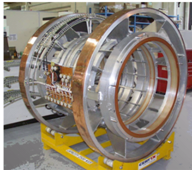
FIGURE 1.25 – Aimant principal supraconducteur d'un IRM.
